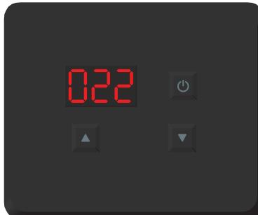
Endre koden 000 til 022 ved hjelp av piltastene og vent et par sekunder.
