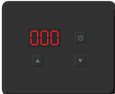
Efter at pil op og pil ned har været trykket ind i ti sekunder, vises koden 000.
