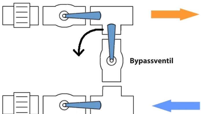
*Öppna först alla ventiler för att enklare justera in bypassen.*
