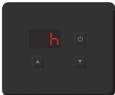
Efter at pil op og pil ned har været trykket ind i et sekund, vises aktuel driftsindstilling.
