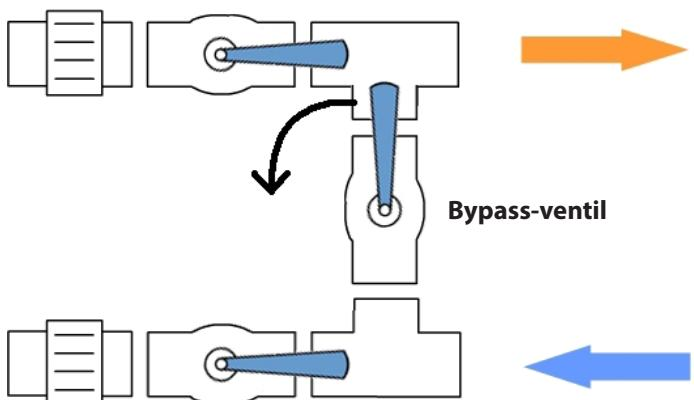
Åpne først alle ventiler for enklere å innregulere bypass.
