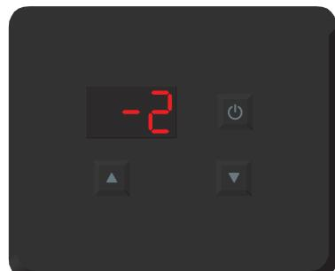
Justér den indstillede værdi ved hjælp af piletasterne. Aktuelle sensorværdier kan ikke ændres.
