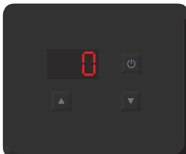
Indtryk pil op og ned i et par sekunder for at få vist indstillet/aktuel værdi for den valgte parameter/sensor.
