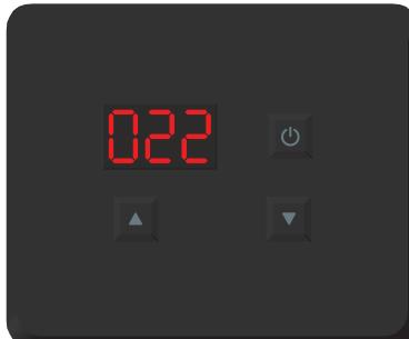
Ändra koden 000 till 022 med hjälp av piltangenterna och vänta ett par sekunder.
