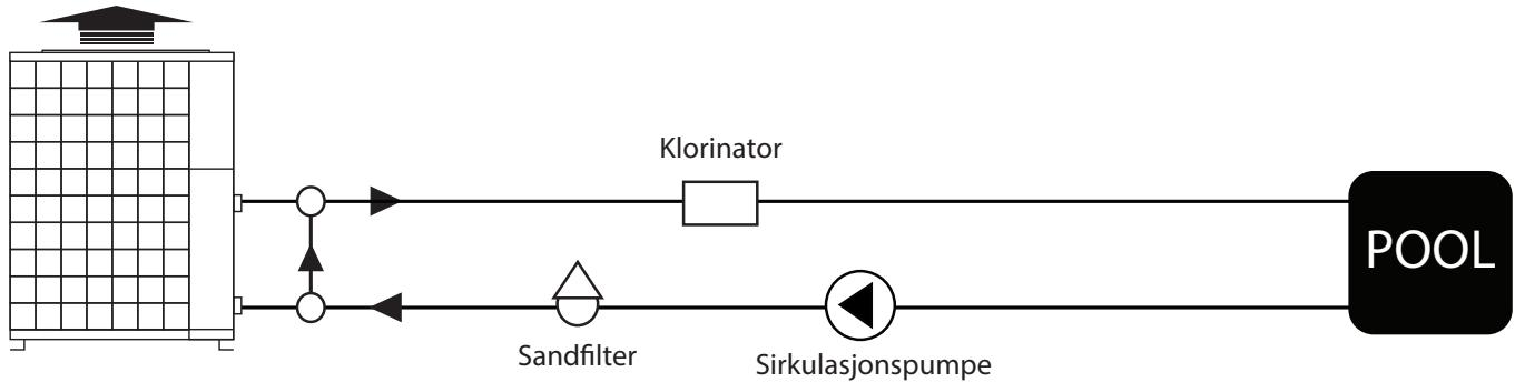
Se etikettene på enheten før tilkobling av inn- og utløp.
