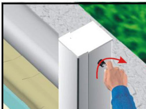
Faites tourner l'arbre moteur avec la clé et au moyen de l'accessoire fourni (en même temps), actionnez le réglage fin de course jusqu'à l'arrêt correct de l'enrouleur (image 3). Renouvelez la manœuvre si besoin jusqu'à obtention du réglage demandé.
