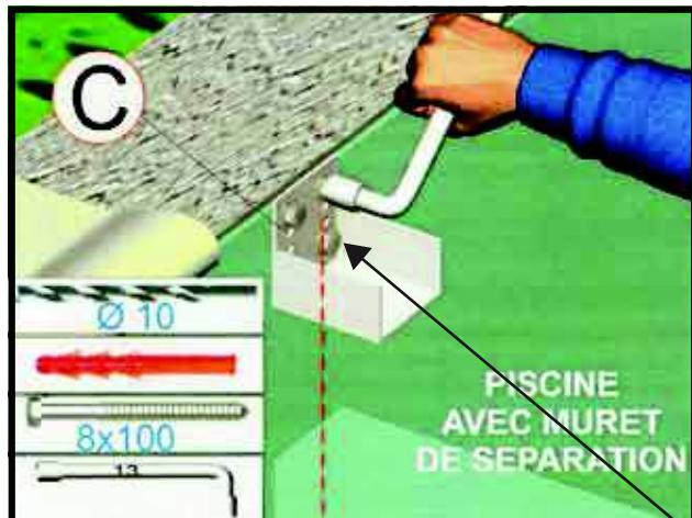
Dans le cas d'une piscine AVEC MURET DE SEPARATION, fixez la poutre à l'aplomb de ce mur en l'alignant comme indiqué précédemment.
