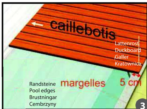
Engagez les caillebotis dans la rainure de la poutre et fixez- les dans la maçonnerie (cote margelles)
