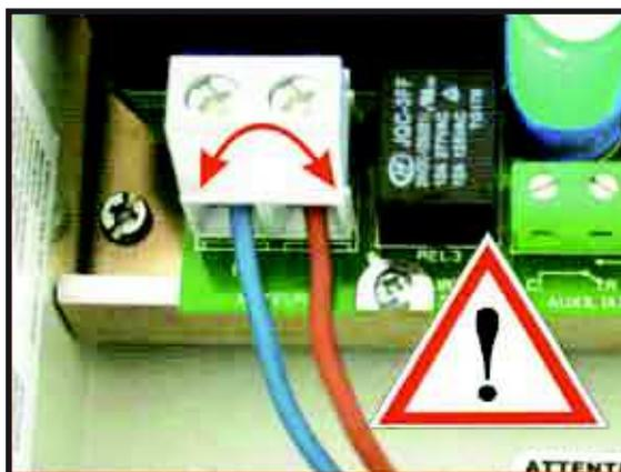
Si photo 6, en tournant la clé, le volet ne repart pas en réglage, inversez les deux fils
