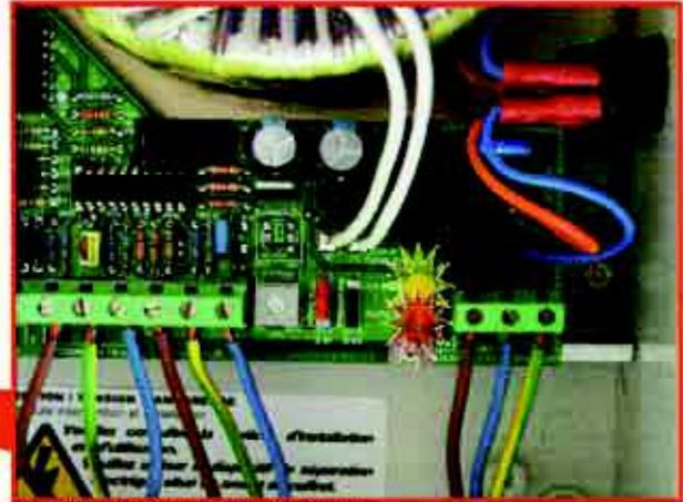
Die rote und die gelbe Leuchtdiode müssen blinken. Ist das nicht der Fall, sind die Elektroanschlüsse zu überprüfen.
