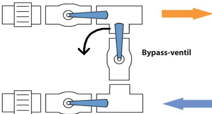
Åpne først alle ventiler for enklere å innregulere bypass.
