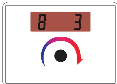
Parameter 8: (0 = Kylläge / 1 = Värmeläge el. kylläge / 2 = Används ej / 3 = Värmeläge)
