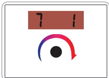
Parameter 7: Automatisk återstart vid strömbrott. (0 = Nej / 1 = Ja)
